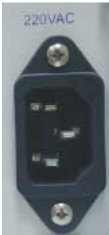
3.2.1) Conexão de rede primária: Disponível no conector padrão IEC. Deve-se ligar a este o 220Vrms (monofásico ou bifásico) e o terra de proteção através do cabo código 63.01.0618.0.9 (vide figura 11).
